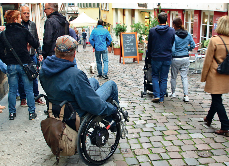
Vor längeren Gefällstrecken sollte man das System besser deaktivieren, um gekippt fahren zu können.
