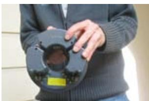
Leistungsfähig: Lithium-Ionen-Akku des e-motion
